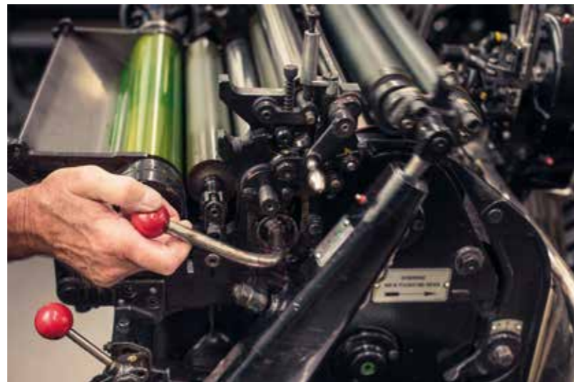
Das Farbwerk der Heidelberger Tiegeldruckpresse.
